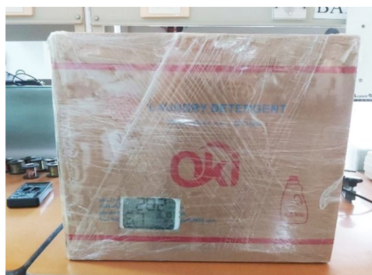
Hình 1. Thùng carton có gắn máy theo dõi nhiệt độ, độ ẩm được bọc bằng màng polyetylen, bên trong chứa hạt hút ẩm
